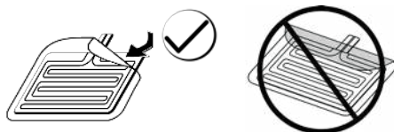
Figura 1: Rimozione del rivestimento
