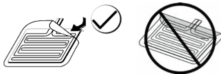
1. ábra: A védőréteg eltávolítása
